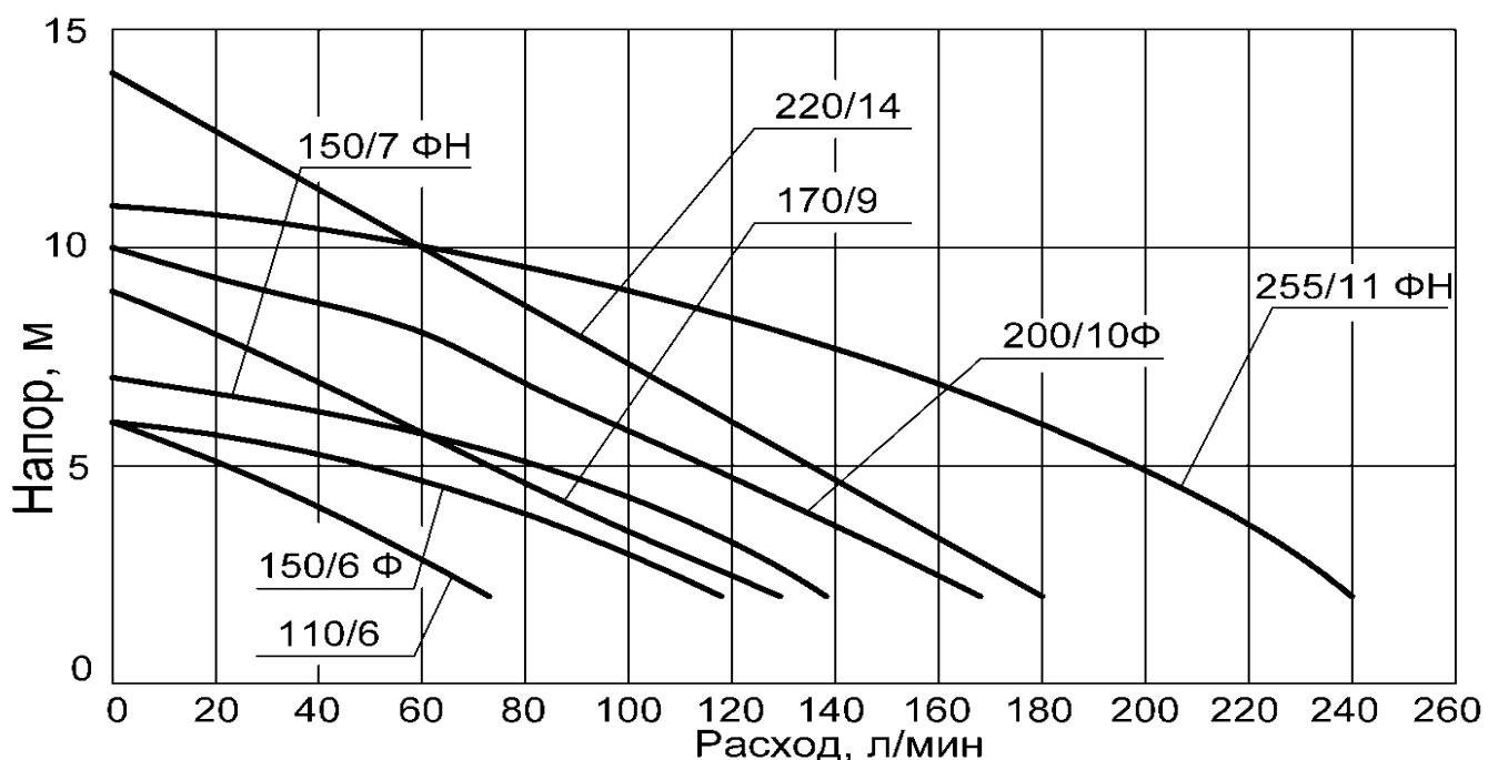
Заявленные характеристики насосов были получены при испытании с напорной магистралью согласно модели насоса и напряжением 220 вольт.
